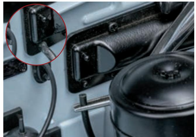
Установите свободный конец выпускного шланга отопителя, идущего от водяного насоса, на нижнем крепежном патрубке радиатора отопителя (на перегородке моторного отсека). При необходимости воспользуйтесь клеем.
