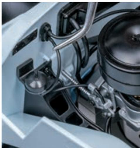
Зафиксируйте свободный конец тяги ручного управления акселератора на крепежном штифте уплотнителя тяг карбюратора на перегородке моторного отсека. При необходимости можно укоротить имитацию тяги.
