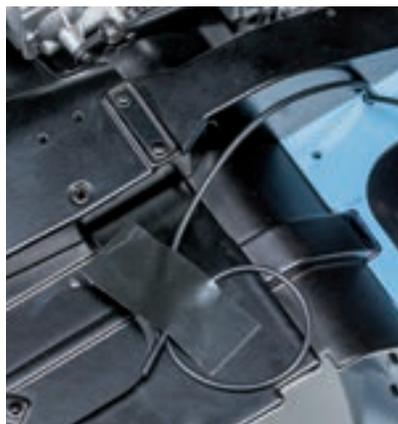
С нижней стороны шасси при помощи клейкой ленты временно закрепите свободный конец топливной магистрали. Фиксация предотвратит случайный разрыв шланга при сборке модели.
