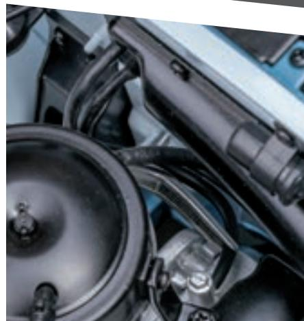
Закрепите шланг, идущий от запорного крана блока двигателя, на верхнем патрубке радиатора отопителя.
