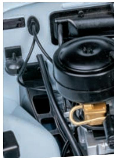
Поместите свободный конец жгута реле-регулятора на крепежном штифте перегородки моторного отсека, расположенном выше правого усилителя переднего лонжерона.
