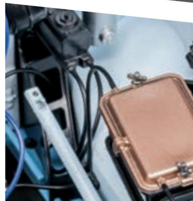
Пропустите провод, идущий от стартера, сквозь фиксатор, расположенный на вертикальной плоскости левого брызговика двигателя рядом с рулевым валом. Далее закрепите провод на крышке аккумуляторной батареи.
